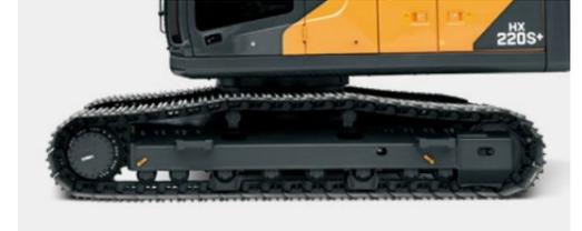
Bastidor reforzado de sección en caja soldado, de acero de alta resistencia y bajo esfuerzo. Garantiza la seguridad y la resistencia contra impactos externos durante la conducción en terrenos accidentados y el trabajo en lugares húmedos, mediante paneles de acero de alta resistencia a la tracción, con rodillos superiores e inferiores de alta durabilidad y protectores de orugas. (HX210/220HD+ : Cubierta para la rueda inactiva reforzada, aplicada)
