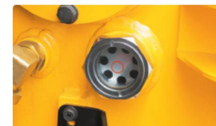
Medidor de aceite hidráulico con visor
