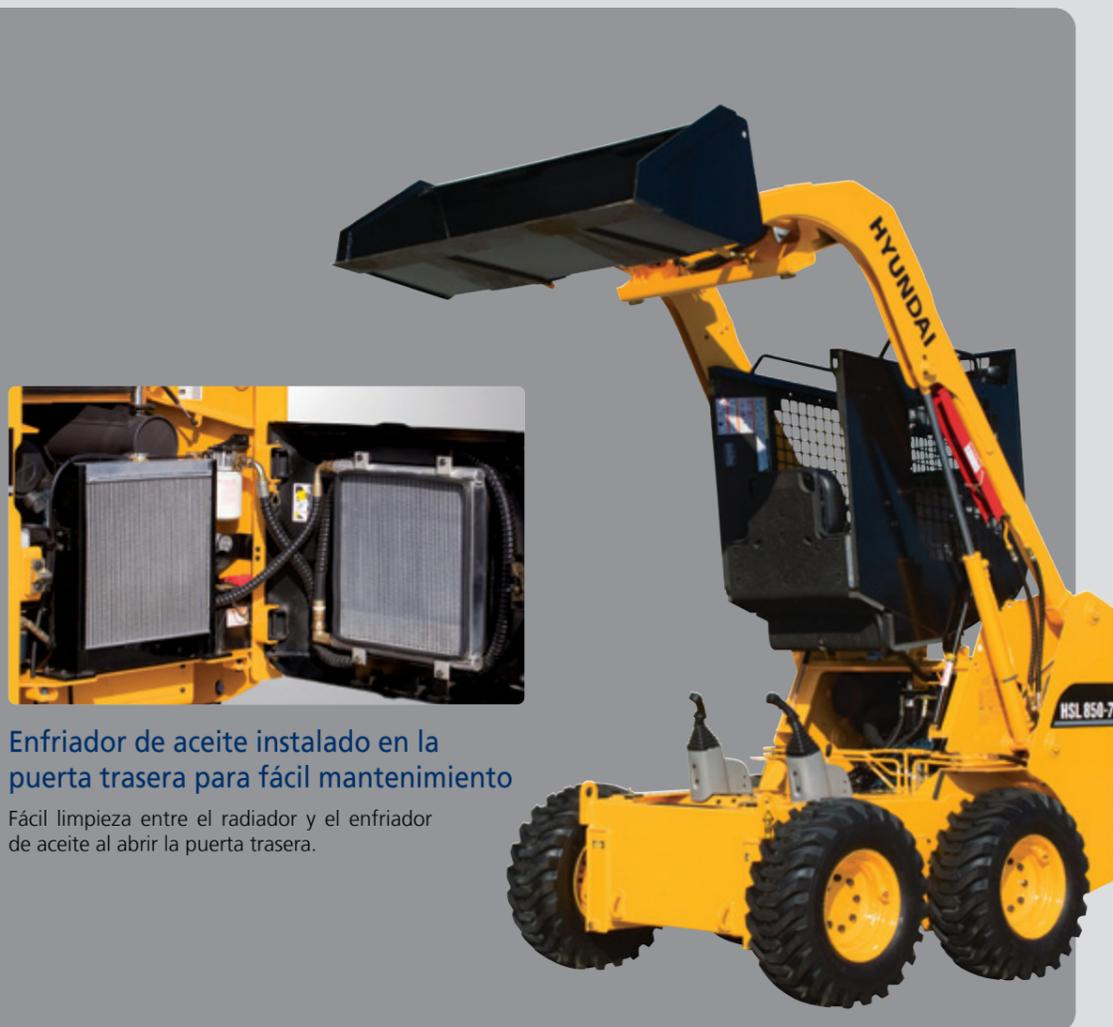
Enfriador de aceite instalado en la puerta trasera para fácil mantenimiento
