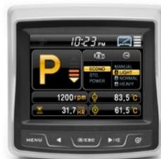
El autodiagnóstico, las listas de comprobación de mantenimiento de la cámara de visión trasera en color, y la seguridad de arranque de la máquina, se han integrado en el monitor, para que la máquina sea más versátil y el operador más productivo. La nueva unidad de visualización del monitor está montada sobre un soporte giratorio ajustable para reducir, el deslumbramiento, y colocarla según las preferencias del operador.
